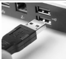
Obrázok 19 USB A port a kábel
